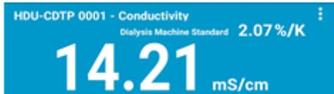
Il s'agit d'un affichage à deux valeurs indiquant un réglage. Ici, "l'étalon de la machine de dialyse" indique le coefficient de compensation de la température de conductivité choisi.
